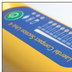
Bedienoberfläche mit An-/Aus Knopf, Anzeige für externe Stromversorgung, Anzeige des Ladestatus der Batterie, LED-Anzeige des Vakuums
